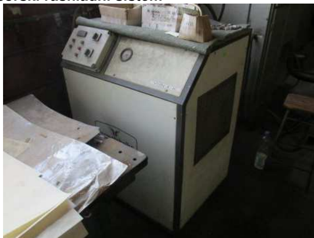
Ad 127 i 208 Kada za impregnaciju namota i Napr.za lakir.rotora u laku
